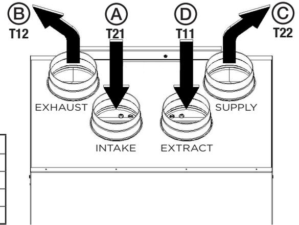
Fig. 7.b Sonde di temperatura SITALI CXVA 400 e SITALI CXVA 550.
