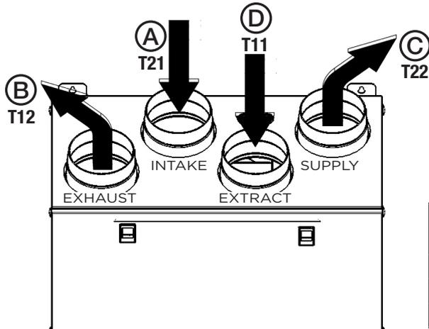
Fig. 7.a Sonde di temperatura SITALI CXVA 280 S1.
