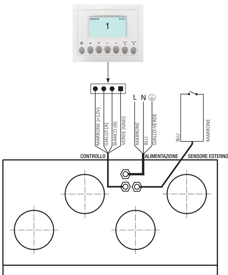
Fig. 5.p Collegamento cavi
